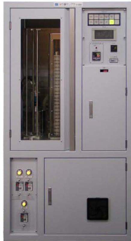
30個式サンプルチェンジャ(S.C)付 ヨウ素サン普拉の例
